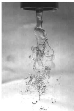
(f) Atomizer 6, u_l=0.88\text{m/s} , u_g=23.2\text{m/s}
