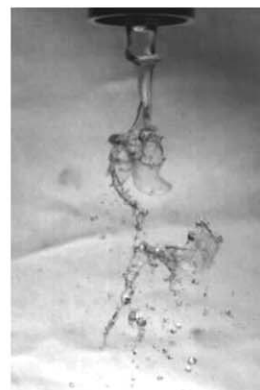
(g) Atomizer 7, u_l=0.44\text{m/s} , u_g=21.7\text{m/s}
