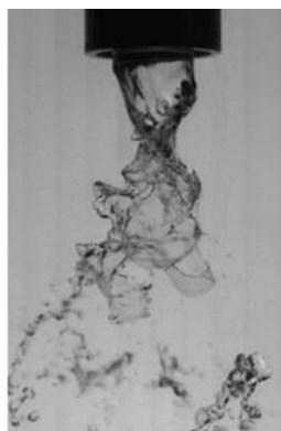
(a) Atomizer 1, u_l=0.17\text{m/s} , u_g=26.9\text{m/s}
