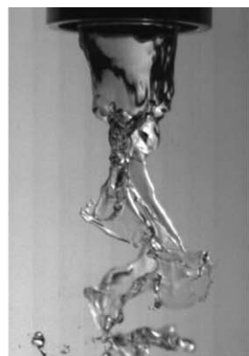
(a) Atomizer 1, u_l=0.17\text{m/s} , u_g=26.9\text{m/s}
