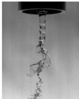
(c) Atomizer 3, u_l=0.88\text{m/s} , u_g=23.2\text{m/s}
